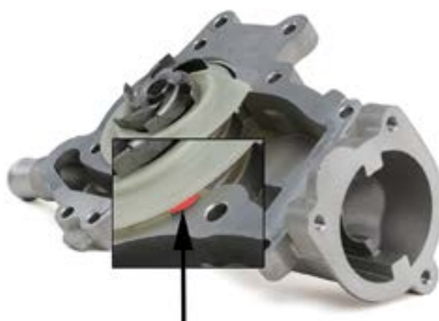
Foto 2: Odształcona plastikowa osłona z powodu niewłaściwego uszczelnienia
